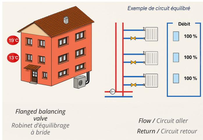
Pour équilibrer l'installation, on monte des Robinets d'équilibrage RC2106 sur les circuits de retour. Ceux-ci vont répartir équitablement les débits dans les colonnes.
