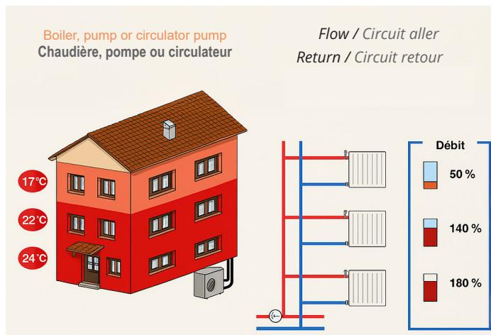
L'installation est composée de 3 colonnes montantes identiques, sans vanne d'équilibrage. Le débit en sortie de chaudière est calculé pour que chaque colonne reçoive un débit identique.
